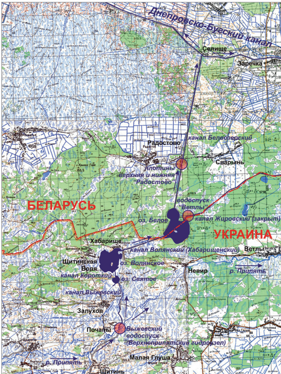
Рисунок 2.1 — Белоозерская водопитающая система Днепровско-Бугского канала
